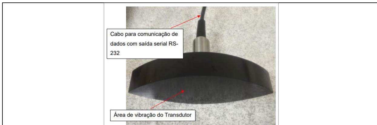
Figura 5: Transdutor utilizado com o ecobatímetro
